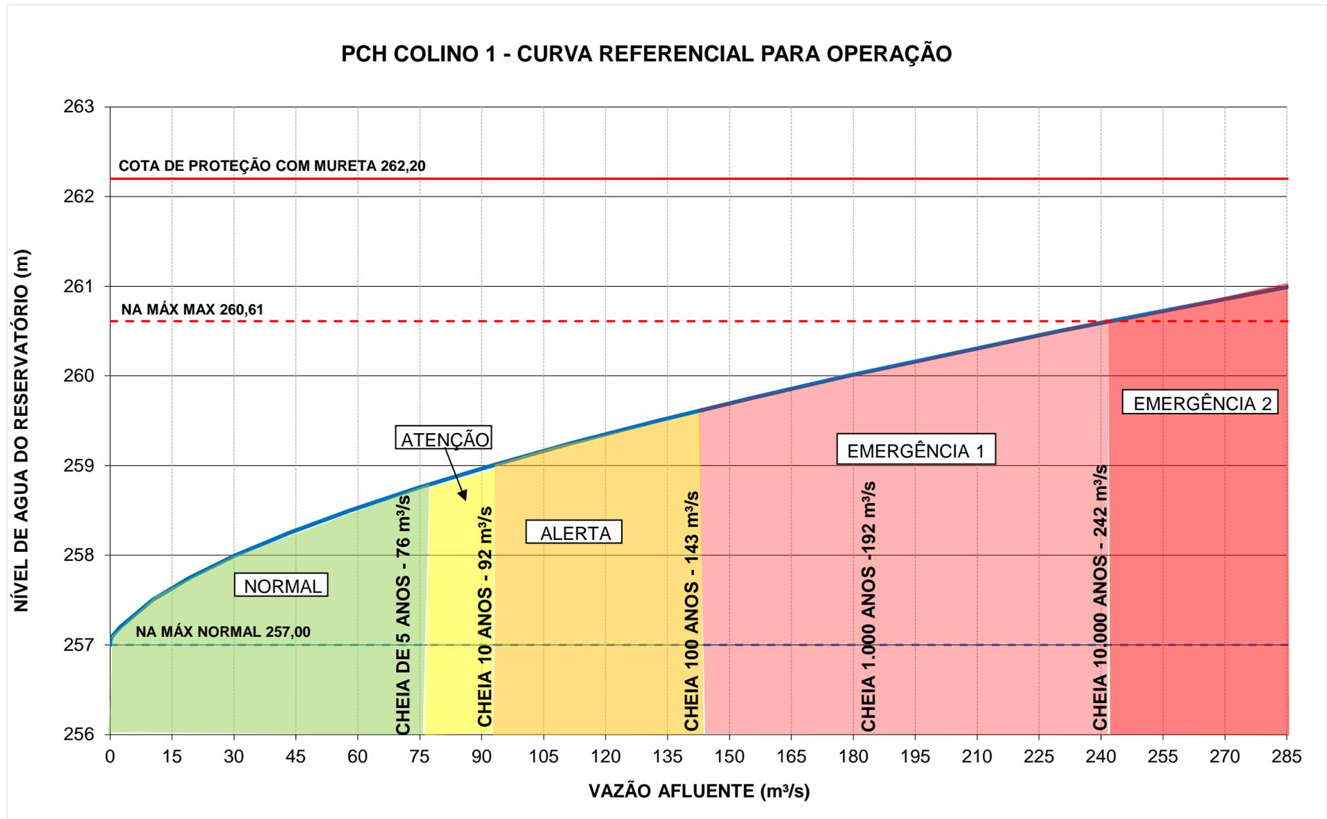
Figura 28 – Níveis de Segurança e Risco de Ruptura
