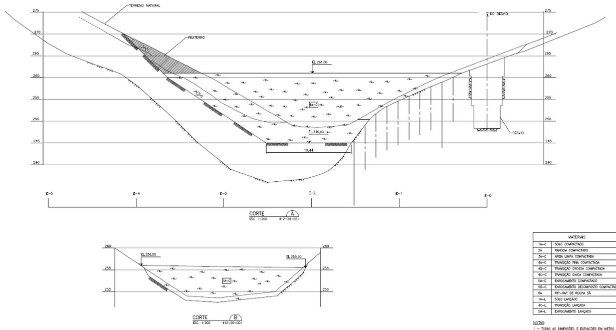
Figura 23 – Seções da Barragem da PCH Colino 1
