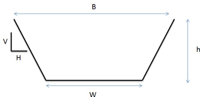
Figura 17 - Representação dos parâmetros de forma da brecha de ruptura
