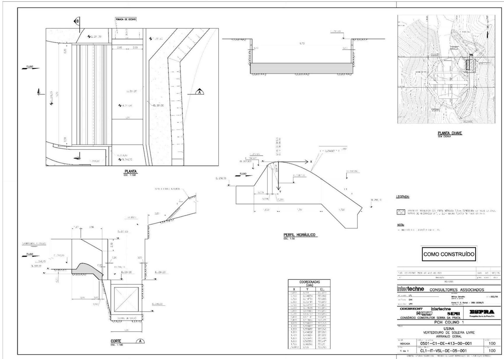
Figura 13 – Plante e Seções do Vertedouro
