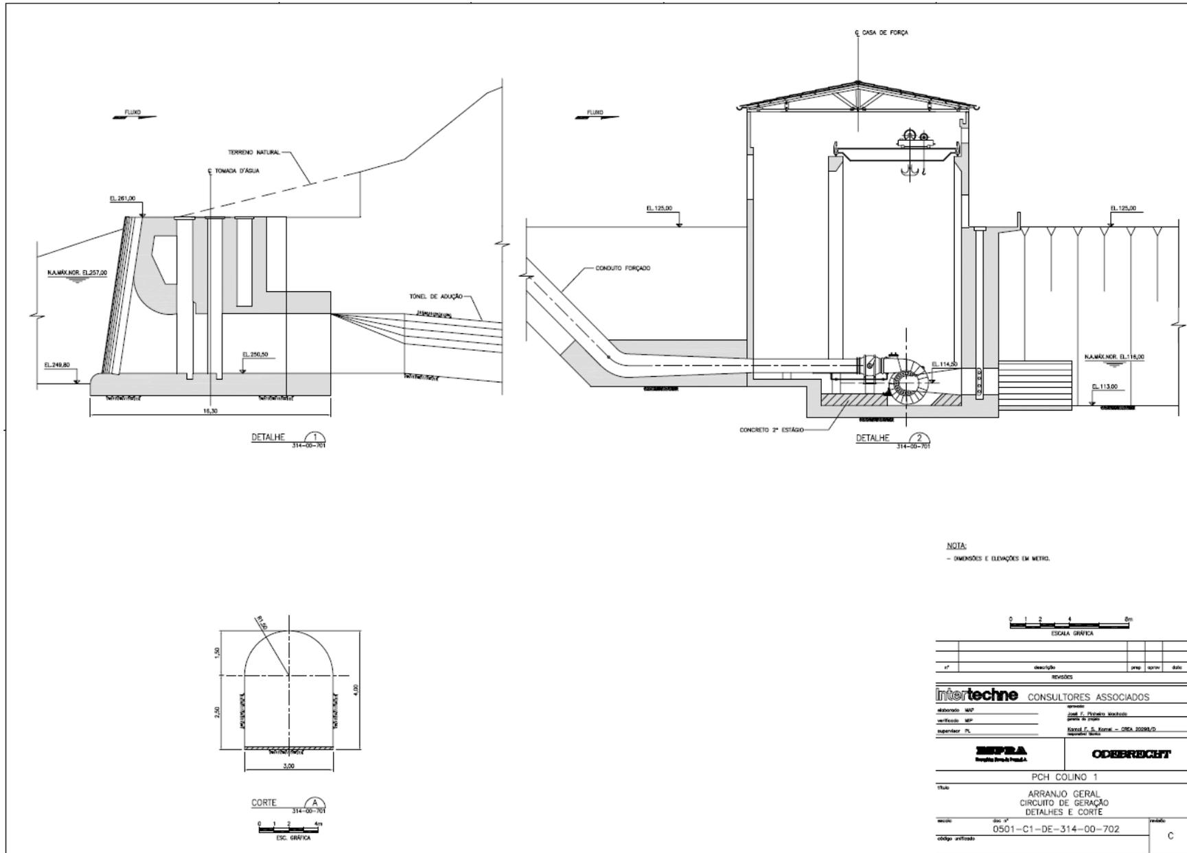
Figura 16 – Circuito de Geração - Detalhes
