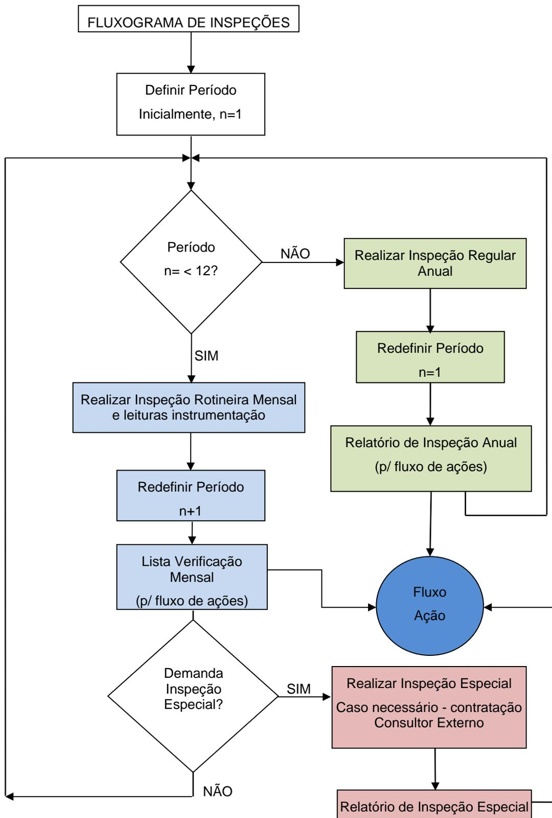
Fluxograma 1 – Fluxograma de Inspeções – n = mês
