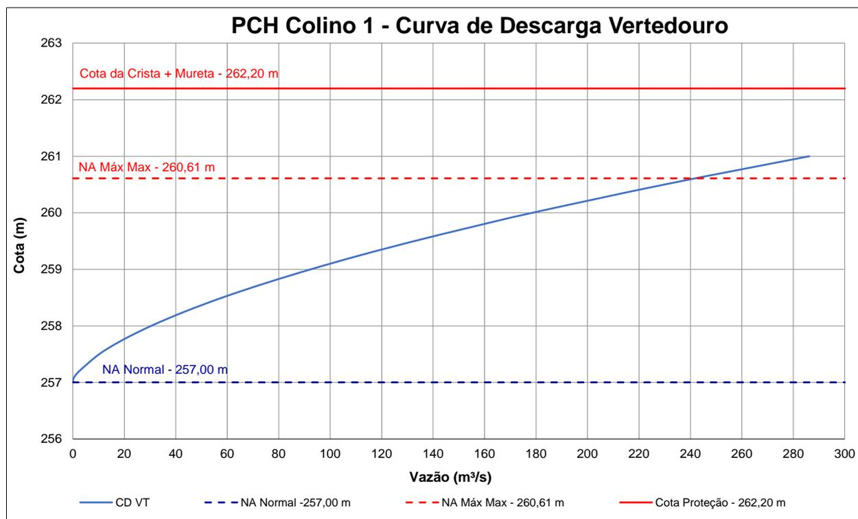
Figura 7 – Curva de Descarga – Vertedouro
